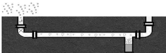
شکل (4): سیستم تولید آب چگالشی برای مصارف خوراکی
