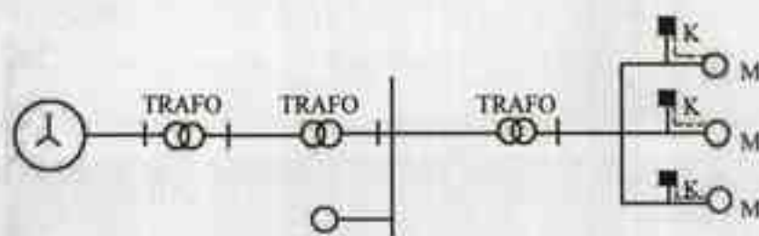
شکل شماره ۴-۱: جیرانسازی اختصاصی
