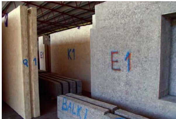
شکل (۶) پنل‌های متشکل از خرده‌های نی و بتن
