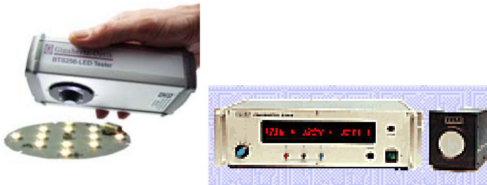
شکل - ۵۱ - دستگاه اندازه گیری جریان فوتون
