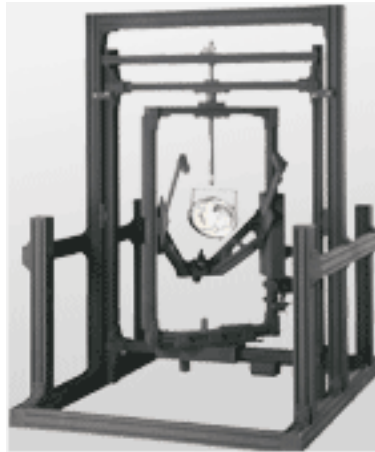
شکل - ۵۴ گونیو با دوربین پیکسل های نوری
