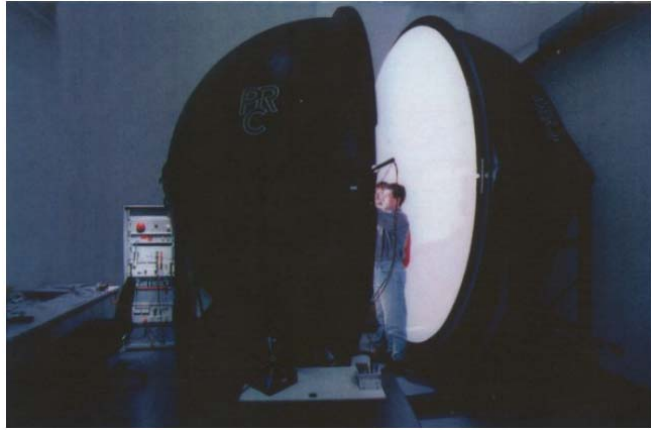
شکل - ۴۴ کره اندازه گیری شار نوری لامپ
