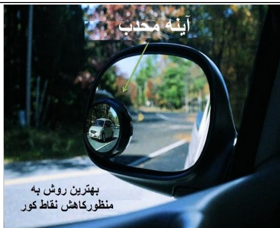
شکل ۳- آینه بغل مجهز به آینه محدب مضاعف جهت دیدن نقاط کور
