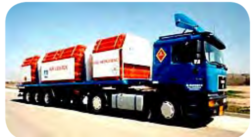
کامیون مخصوص حمل هیدروژن فشرده
