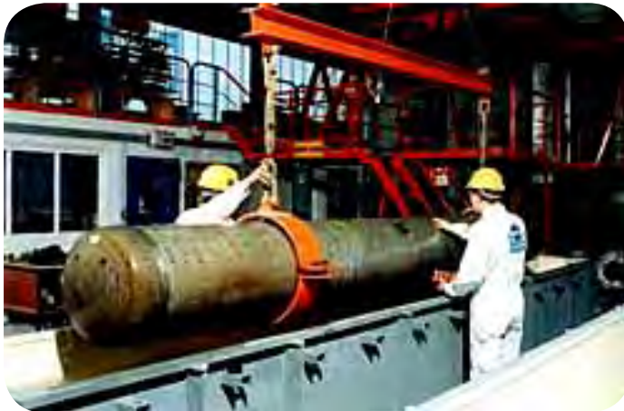
مخزن ذخیره سازی از نوع هیدرید فلزی در مقیاس بزرگ
