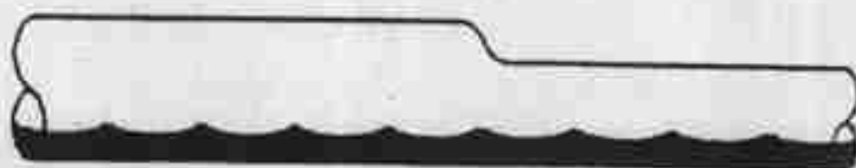
شکل ۱۸-۳- روش صحیح تغییر قطر در خط لوله توزیع بخار
