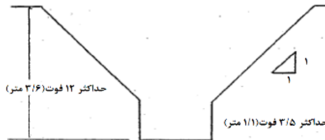
شکل ۳۰: گودبرداری‌های با عمق ۸ تا ۱۲ فوت حمایت نشده
